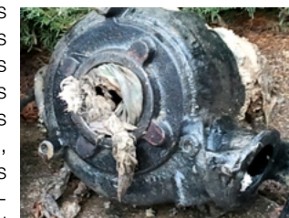
Pompe de relèvement d'eaux usées obstruée par des lingettes
