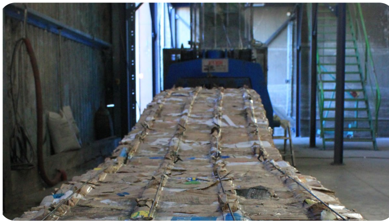
Compacteur de cartons pour la réalisation des balles pour le transport
